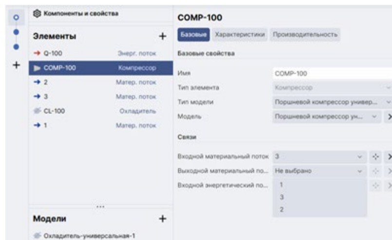
Рис. 26. Редактирование схемы через раздел «Связи» у элементов-аппаратов
